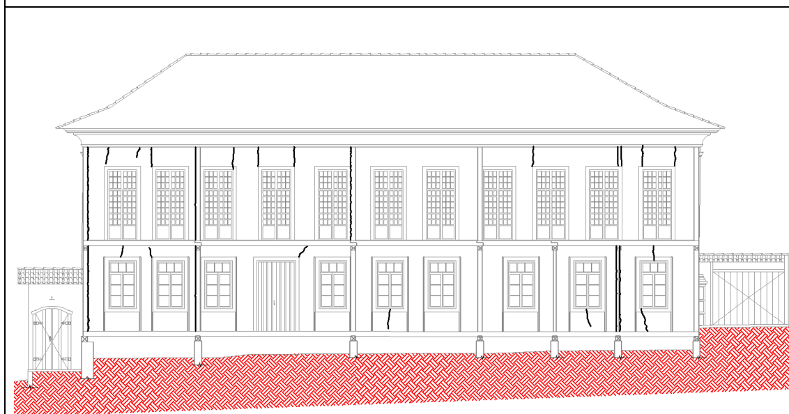
Imagem 42 – Croqui sem escala, da parede da fachada principal da edificação, vista interna, com a indicação das principais trincas e fissuras existentes.
